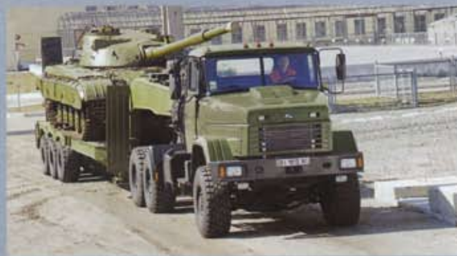
Седельный тягач КрАЗ T17.0EX «Титан-02» для перевозки тяжелых грузов, в т. ч. танков. Полная масса полуприцепа – до 75 т.
