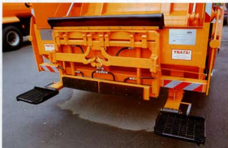
Узел загрузки/выгрузки ТБО оснастили не только надежной гидравликой, но и системой защиты окружающей среды от протекания жидких компонентов прессования
