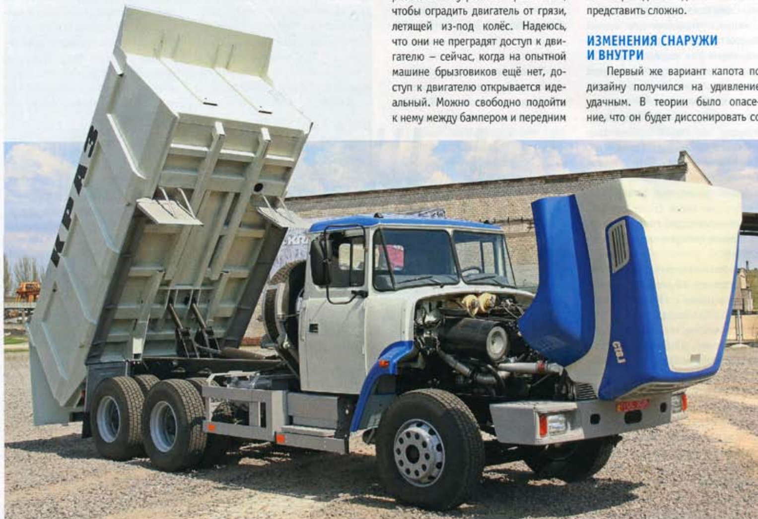
Капот откидывается вперед на большой угол и не перекрывает доступ к двигателю
