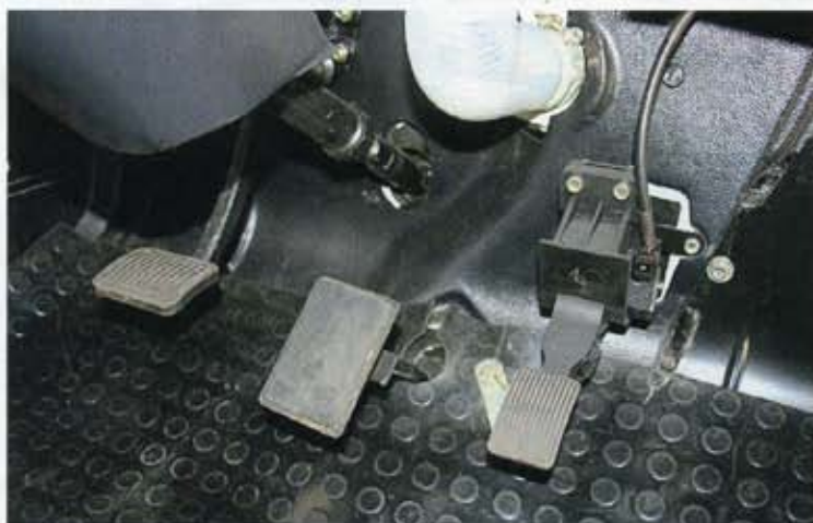
Педальный узел комбинированный: если педаль газа стоит электронная, а сцепления с верхней навеской, то педаль тормоза установлена по старинке на полу и вместе со всей тормозной системой явно выбивается из современного уровня всего автомобиля
