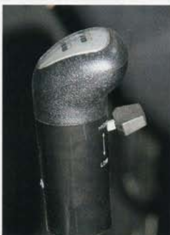
Клавиша перехода с нижнего на верхний ряд передач находится на ручке рычага коробки передач
