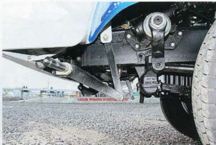
В закрытом состоянии рычаги капота висают под бампером и теоретически появляется вероятность их повреждения, например, когда автомобиль застрял и его вытаскивают буксиром. К сожалению, такой вариант событий на наших стройках не редкий
