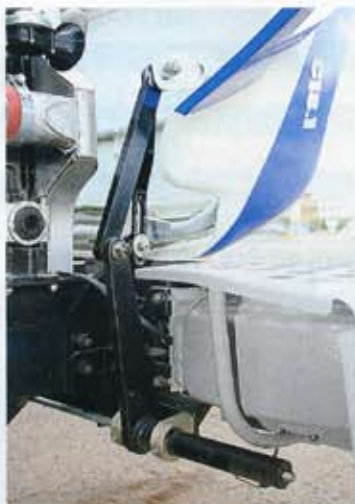
Открывать капот помогает торсионная подвеска с системой рычагов, установленных за передним бампером
