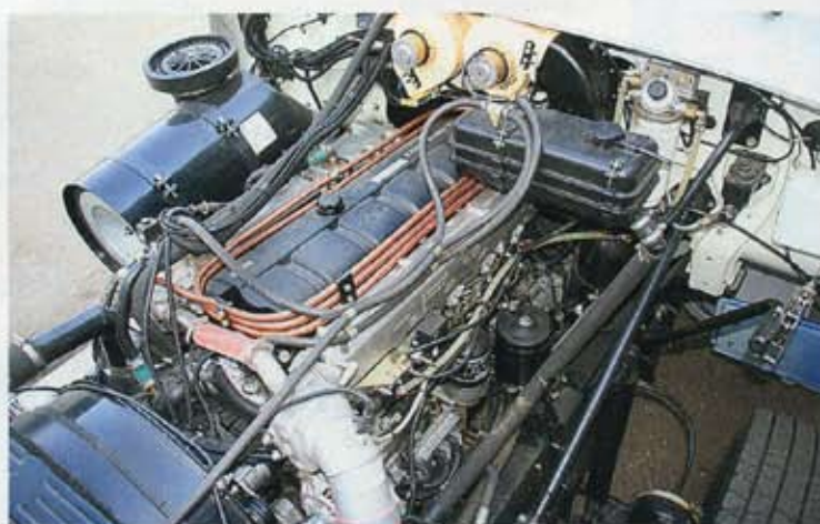
Двигатели семейства ЯМЗ-650 созданы по лицензии и технологиям компании Renault Trucks и представляют собой модернизированный двигатель серии DCi11
