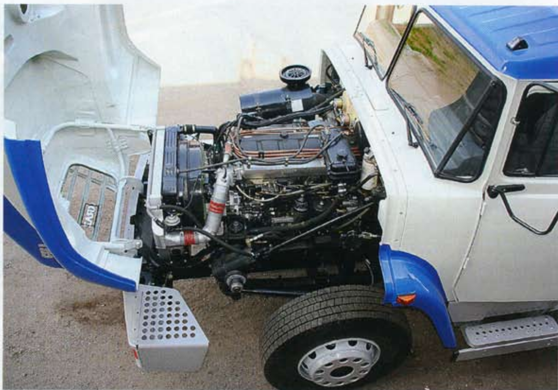
На фотографии наглядно видны новые возможности доступа к агрегатам при обслуживании двигателя
