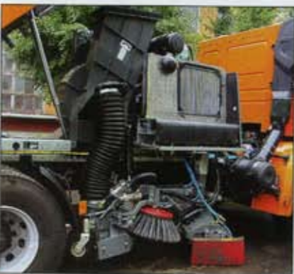
▲ Автономный двигатель привода цилиндрической и дисковой щеток и «пылесоса» с всасывающим раструбом.
