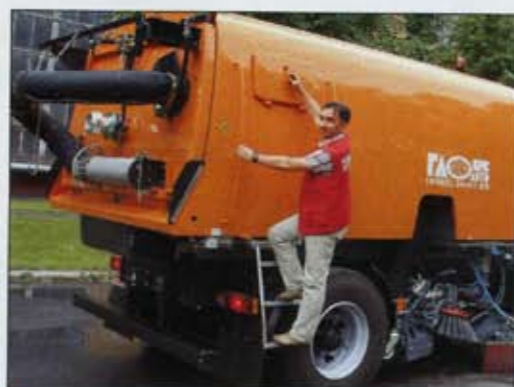
▲ На корме - оборудование для ручной уборки мусора и мойки после работы. Выдвижная лесенка ведет к смотровому люку б-кубового бункера.
