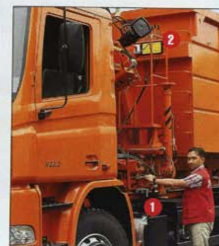
◀ Кран-манипулятор имеет два пульта управления: с земли 1 и с верхней площадки 2, позволяющей наблюдать за размещением груза в кузове.
