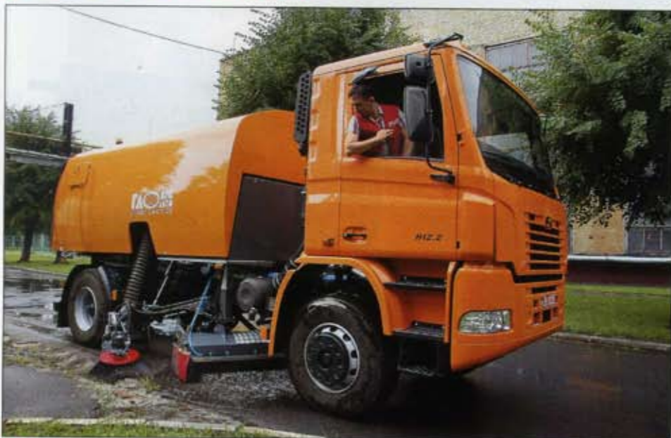
▲ Маневренный двухосный бескапотник КрАЗ К12.2, укомплектованный мощной подметально-уборочной установкой Bucher, быстро и качественно расчистит полосу дороги шириной 2,3 м.
