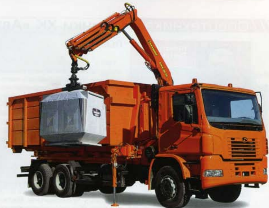
▲ Кран-манипулятор КМУ-90-1 с контейнерным захватом для механизированной загрузки мусора в бункер из евроконтейнеров.
