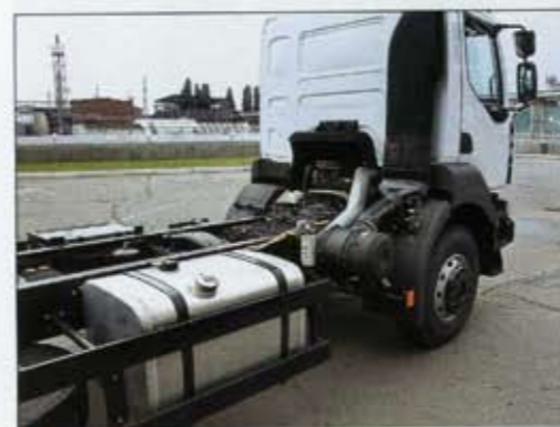
▲ Новый алюминиевый бак оборудован электронным датчиком запаса топлива.
